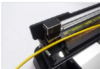
Укладка кабеля в нагреватель – 250, 900, 2.0~ 4.0mm
