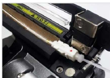
Если при термоусадке трубки при установке коннектора – SC/ FC/ ST/ LC, дополнительный блок мешает коннектору, то его следует снять
